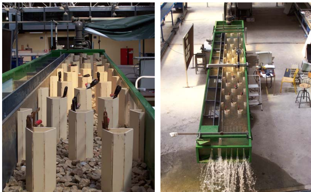
Figure 4. Canal à rugosités artificielles.
