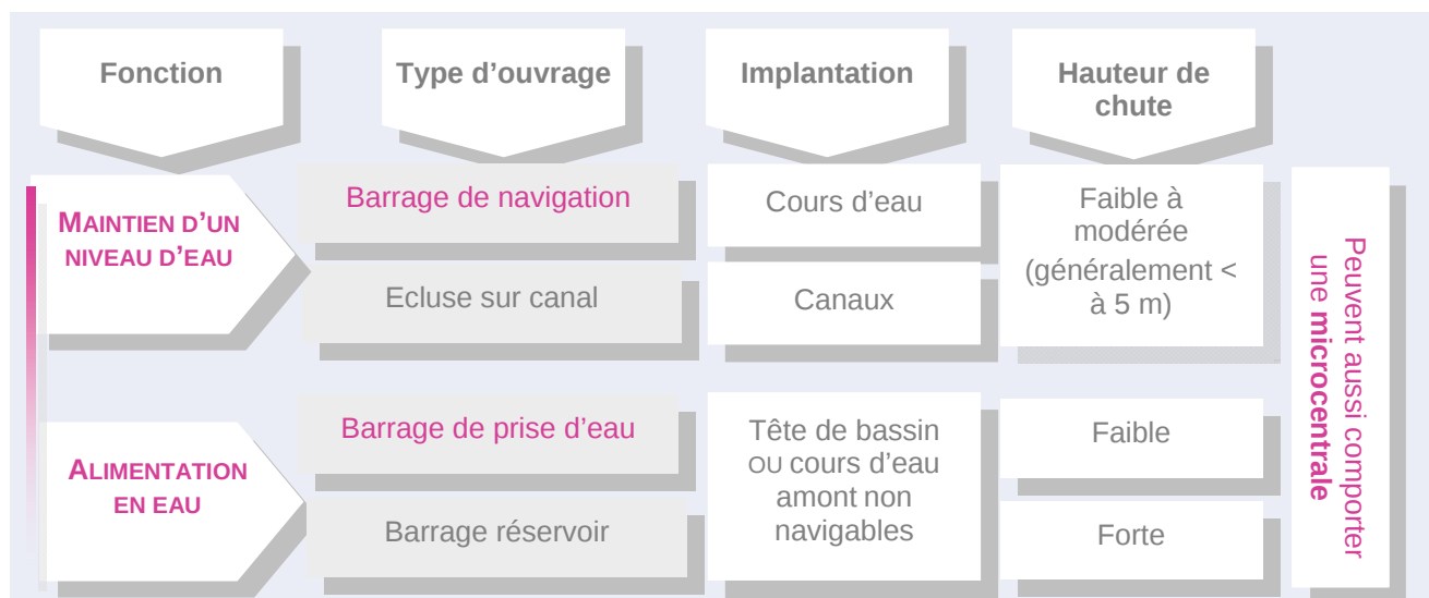
Figure 3: Typologie simplifiée des ouvrages VNF
