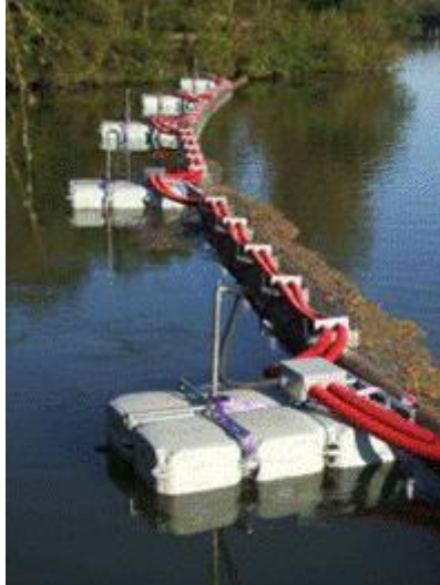
Test d'une barrière à infra-sons (© pôle écohydraulique, OFB)
