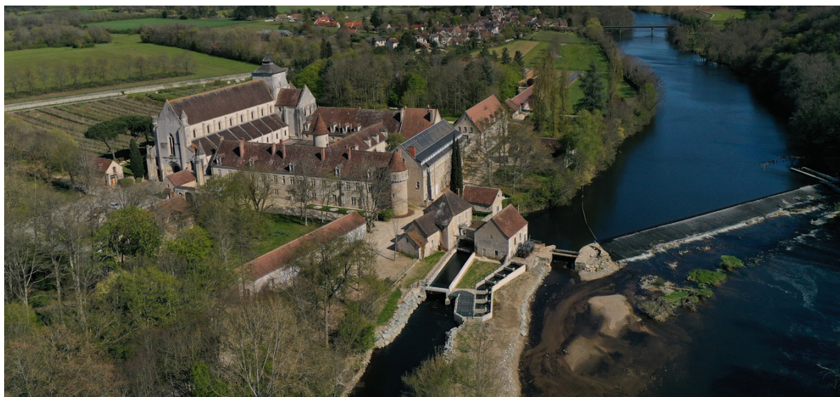
Abbaye de Fontgombault prises par drone après les travaux avec la passe à bassin successif en rive droite, et la passe à macrorugosité en rive gauche.
